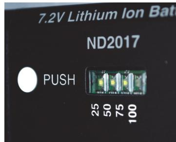
Рис. 4-1 Кнопка состояния заряда батареи
