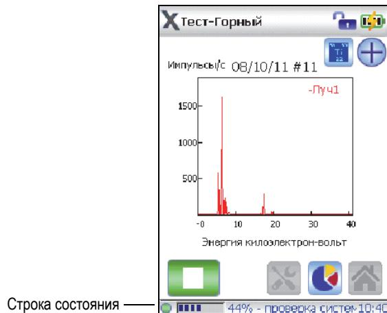
Рис. 3-3 Страна состояния внизу экрана
